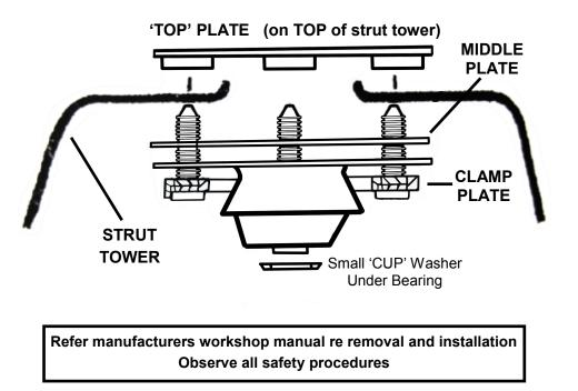
INITIALLY SIT KMAC ADJUSTERS ON TOP OF STRUT TOWERS...
